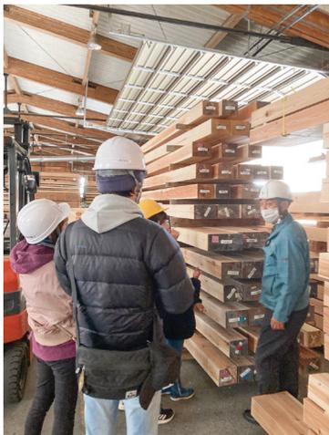
地元の天竜材、それも天然乾燥の天竜材による木造建築に力を注いでいます。天然乾燥の天竜材は、他の木材に比べ粘りがあり、耐震面で強度が高いため、構造材として適しています。また、伐採の時
