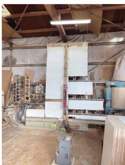
板を切断する機械パネルソー
