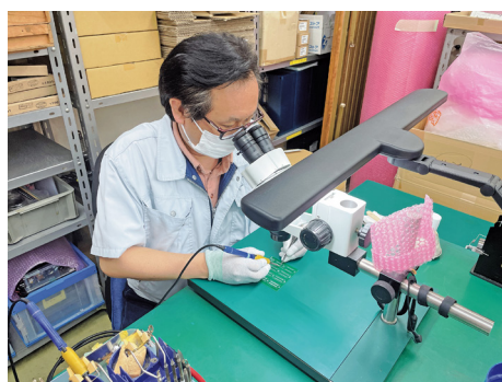
手作業での半田付け
